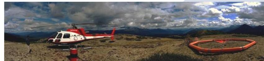
Система ZTEM – магнитовариационный метод из области аудиоманнитотеллурики. Обладает максимальной глубиной исследований из всех аэроЭМ систем и технологий
